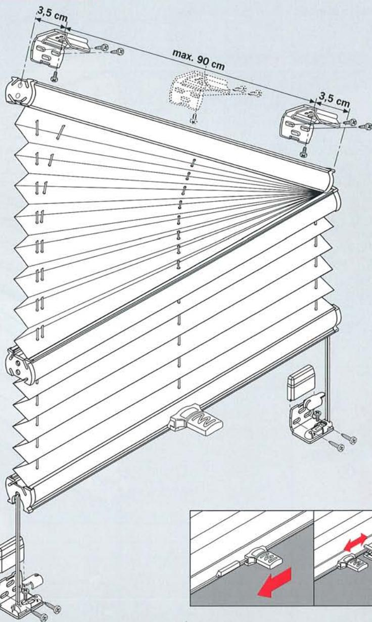
Demontage • Disassembly • Demontage • Démontage • Smontaggio • Демонтаж
